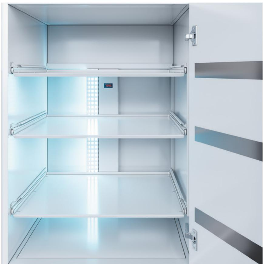
Модуль бактерицидный используется для сохранения стерильности инструментов после дезинфекции . Оснащен датчиком наработки часов УФ лампы и выдвижными полками. Источник ультрафиолетового излучения - безозоновая лампа с длиной волны 253,7 нм. При открытии дверцы лампа автоматически отключается, а при закрытии загорается вновь. На дверце установлены противоударные полоски из нержавеющей стали.
