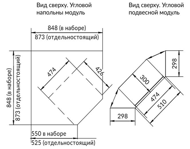
Глубина стационарного модуля со столешницей: 550 мм., без столешницы 448 мм.
