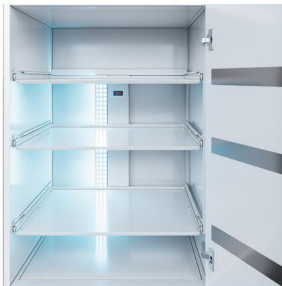
Модуль бактерицидный используется для сохранения стерильности инструментов после дезинфекции. Оснащён датчиком наработки часов УФ лампы и выдвижными полками. Источник ультрафиолетового излучения - безозоновая лампа с длиной волны 253,7 нм. При открытии дверцы лампа автоматически отключается, а при закрытии загорается вновь. На дверце установлены противоударные полоски из нержавеющей стали.
