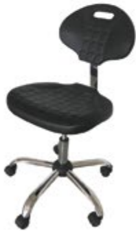
СТЗ-2 (ЛАБ) материал: антистатический мягкий литой полиуретан спинка: 390 мм * 280 мм сиденье: 465 мм * 410мм держатель спинки хромирован- ный, механизм оцинкован- ный,колеса антистатические полиамидные с мягкой шинкой регулировка высоты 435-570 мм доп.функции: качание спинки, регулировка спинки по высоте, регулировка глубины сидения
