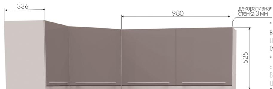
\* габаритные размеры отдельностоящего модуля
