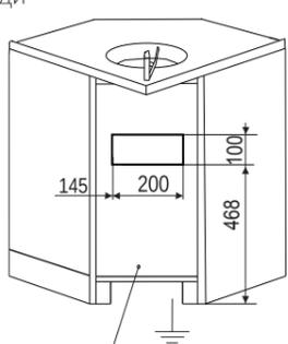
Вид модуля сзади А-10-2М
