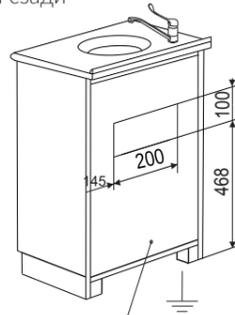
Вид модуля сзади А-10М\*
