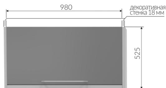
\* габаритные размеры отдельного модуля
