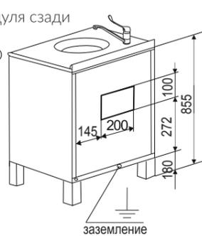
Вид модуля сзади П-10-2М
