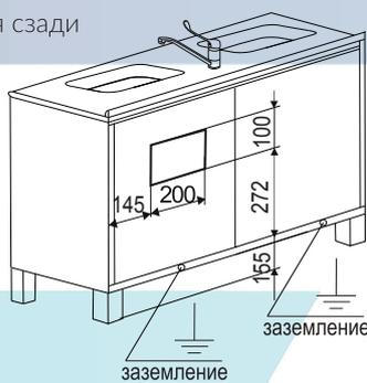
Вид модуля сзади P-10M\*
