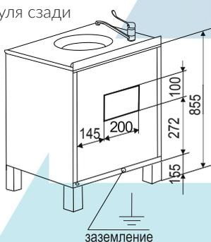
Вид модуля сзади P-10-2M
