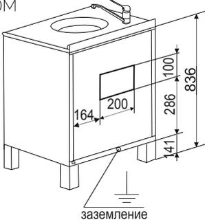
Вид модуля сзади П-10-2М
