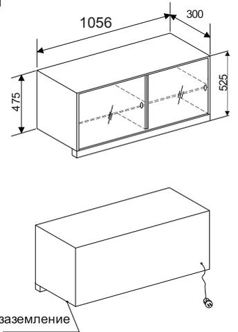
Вид модуля сзади П-10М
